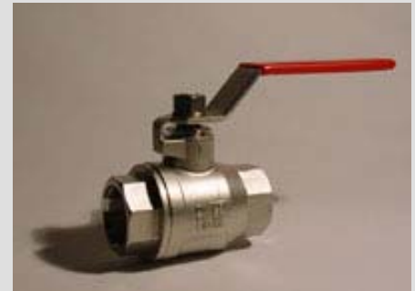
2-Wege Edelstahl Kugelhahn, voller Durchgang, Gewinde nach DIN 2999, 2-teilig, PN63
