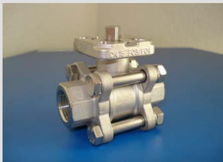
2-Wege Edelstahl Kugelhahn, voller Durchgang, Gewinde nach DIN 2999, Baulänge nach DIN 3202 M3, 3-teilig, PN63, ISO Aufbau für Antriebe
