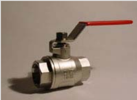
2-Wege Edelstahl Kugelhahn, voller Durchgang, Gewinde nach DIN 2999, 2-teilig, PN63
