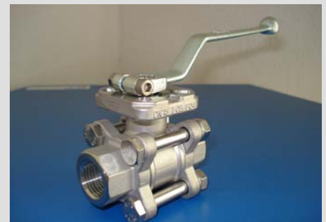
2-Wege Edelstahl Kugelhahn, voller Durchgang, Gewinde nach DIN 2999, Baulänge nach DIN 3202 M3, 3-teilig, PN63, ISO Aufbau für Antriebe
