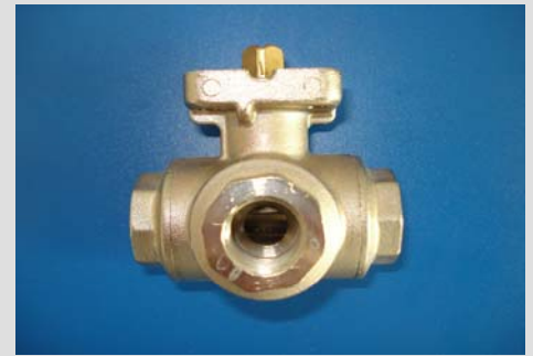
3-Wege Messing Kugelhahn, voller Durchgang, Gewinde nach DIN ISO 7/1 (UN EN 10226), ISO Aufbau für Antriebe
