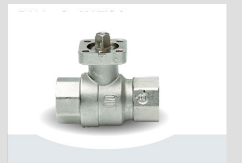
2-Wege Messing Kugelhahn, voller Durchgang, Gewinde nach DIN ISO 7/1 (UN EN 10226), ISO Aufbau für Antriebe
