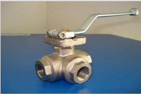
3-Wege Messing Kugelhahn, voller Durchgang, Gewinde nach DIN ISO 7/1 (UN EN 10226), ISO Aufbau für Antriebe
